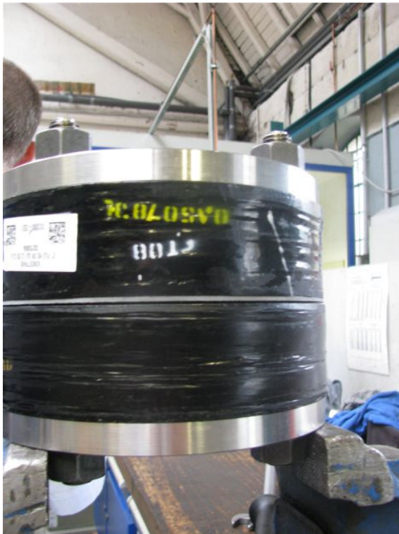
Bild 3: Gesamtansicht der Verbindung, in der Mitte ist der Stützring der Dichtung zu erkennen
