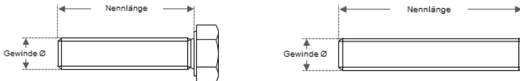
Abb.1: Festlegung der Nennlänge bei Kopfschrauben (z.B. ISO 4017) und Gewindebolzen (z.B. DIN 976-1, Form B)
