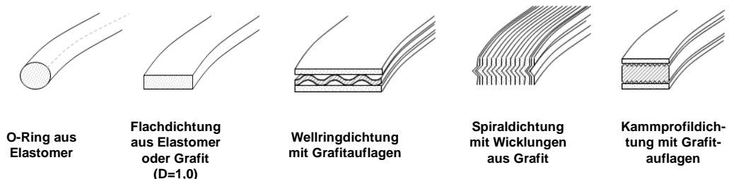
Abb.4: Dichtungen die für den Einsatz im Kraftnebenschluss geeignet sind
