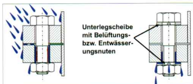
Bild 2: Korrosionsschutz durch Unterlegscheiben mit Entwässerungsnuten (Bild: Peter Thomsen)
