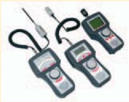
» 3 Moderne SONAPHONE-Prüfgeräte dienen der effektiven Leckageortung
